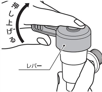
レバーを「しめる」の方向にまわし、片方の手でコック本体を押さえ、もう片方の手の親指でレバーを強く押し上げると「カチッ」と音がして外れます。
